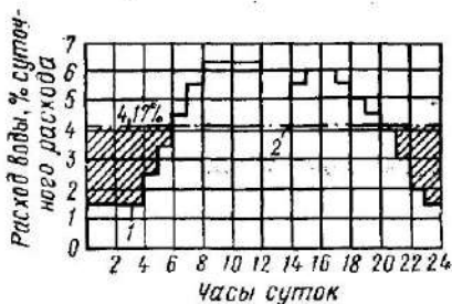
Рис. 11.39. Ступенчатый график подачи и потребления воды
